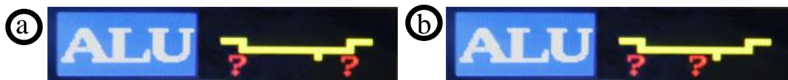
Fig. 7.7 Afbalanceringsklods ikon a: Begyndelse af fase 2 b: Når målearmen bevæges ind i fælgen.
